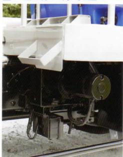
バッテリー駆動の電動式真空ポンプを装備。ドラム内が真空になるまで自動運転し、その後停止します。真空ポンプの長寿命化をはかり、オイル消費量も減り、経済的です。
