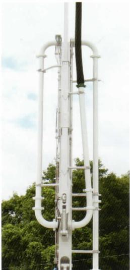
ブーム配管には摩耗検知穴付きロングエルボパイプを使用。生コンクリートの流動性が向上し、配管抵抗が少なくなりました。圧送中のブームの揺れを少なくするために、貫通式連結ピン構造にしました。
