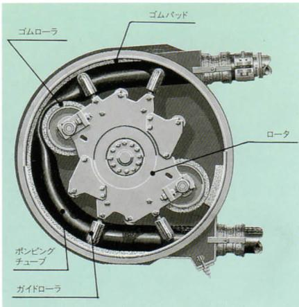
安定した圧送性能を持つ真空スクイーズ式ポンプを搭載。ドラム内の真空がローラで押し潰されたポンピングチューブの復元を助け、定量の生コンクリートを吸込み、常に安定した吐出量を保ちます。ポンピングチューブ径が4.5B、最大吐出量が50m<sup>3</sup>/hのスクイーズクリートPH50B-17は、高度な機能を小型車に満載しました。また、油圧モータでローラを直接回転させるパワーローラ式を採用。ギヤやチェーンを使わないシンプルな構造とし、ローメンテナンス費用を実現しました。
