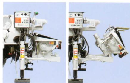
生コンの吸込効果が良く、残コンが少なく、洗浄も簡単な球形ホッパ。ポンピングチューブの交換時間に、作業スペースを大きく確保し、交換時間の短縮を図るチルト機能を装備させました。
