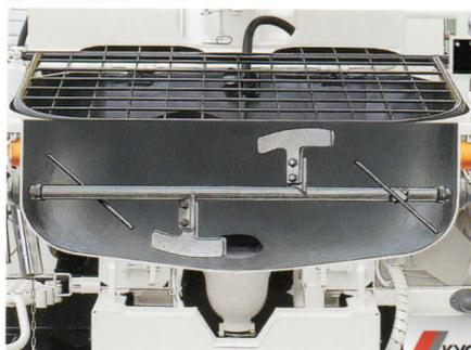
生コンが吸入口に集まりやすい舟底ホッパ。吸込み効率がよく、残コンが少なく、洗浄も簡単に行えます。
